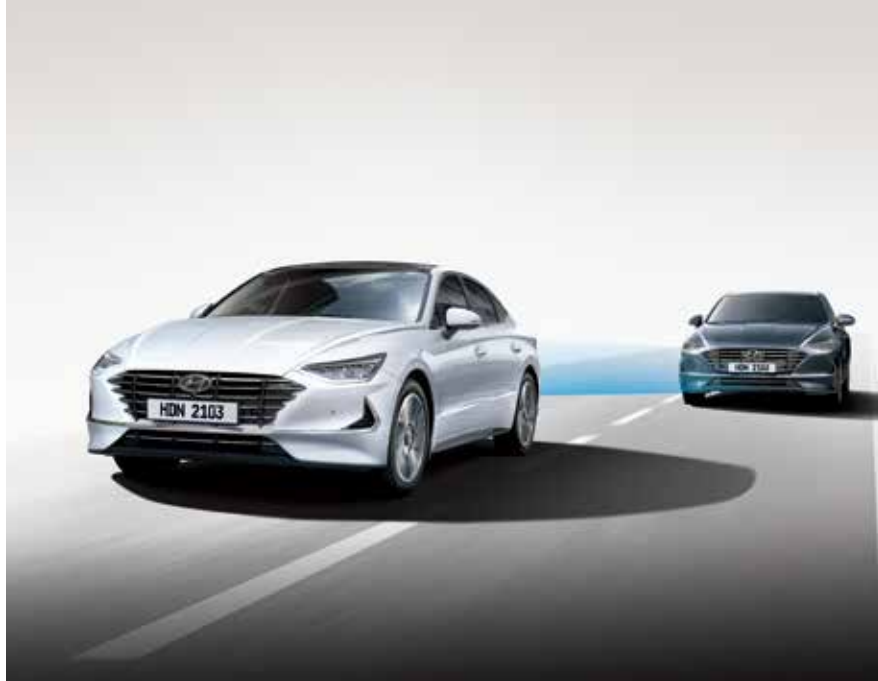
نظام مساعد لتجنب التصادم في النقاط العمياء (BCA) يتم استخدام أجهزة استشعار الرادار الموجودة في المصد الخلفي لتحذير السائق من اقتراب المركبات في منطقة النقطة العمياء. وتعمل على تنشيط نظام التحكم في الثبات الإلكتروني واستخدام المكابح عند خطر الاصطدام أثناء مناورات تغيير المسار. وينشط هذا النظام عند السرعات التي تزيد عن 40 كم/ساعة وعلى الطرق المرسومة بعلامات على كلا الجانبين.
