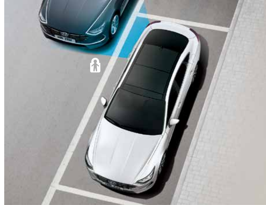
نظام مساعد في المغادرة الآمنة (SEA) يُوقف النظام المساعد في المغادرة الآمنة أي محاولة لفك قفل أمان الطفل ويمنع فتح الباب الخلفي عندما يكون ذلك غير آمناً. وعند اكتشاف وجود أحد ركاب المقعد الخلفي واستشعار اقتراب سيارة من الخلف. يصدر هذا النظام تحذيراً صوتياً وكتابياً لتنبيه السائق إلى وجود خطر.
