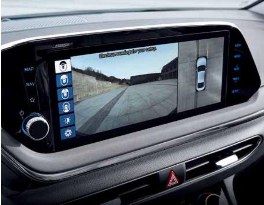
شاشة المشاهدة المحيطة (SVM) تستخدم شاشة المشاهدة المحيطة وحدة الرأس لتتيح مشاهدة محيطية للسيارة وما يوجد حولها. يصبح هذا النظام الاختياري جاهز للاستخدام عند محاولة ركن السيارة في مكان ضيق.
