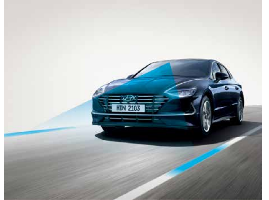
نظام مساعدة التزام منتصف المسار (LFA) يقوم بإستخدام الكاميرا الأمامية للتعرف على الممر ومساعدة السياره في القيادة في منتصف الممر. إذا لزم الأمر . يتحكم تلقائياً في عجلة القيادة للمساعدة على منع الابتعاد من السيارة
